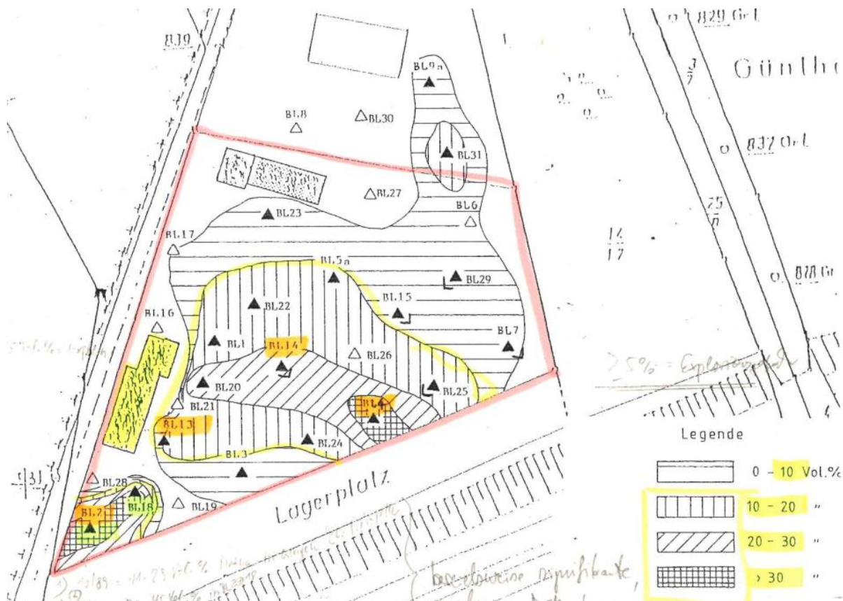
Abb. 13: Methanbelastung im südlichen Plangebiet , Quelle: RP Dez. 41.4, Institut f. Angewandte Geowissenschaften der JLU Gießen, 20.07.1990,
